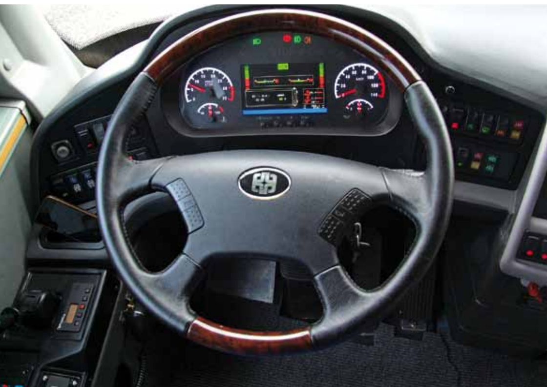
Überarbeitet wurde das Cockpit, die Schalttafel sitzt nun gerade, das Lenkrad wurde verkleinert, es gibt ein Display
